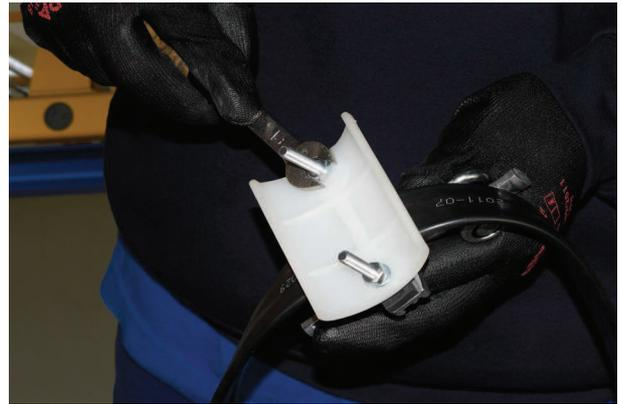
Apretar los tornillos de las bandejas evitando dañar los cables eléctricos por un excesivo apriete.
